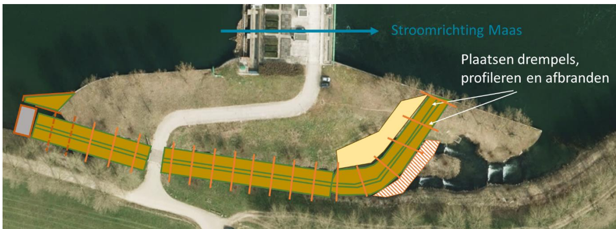
Figuur 7-8 Fase 7: Bodem laatste bekkens profileren
